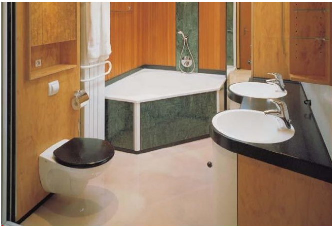
Badewanne mit Naturstein Verkleidung und Feuchtpaneel
